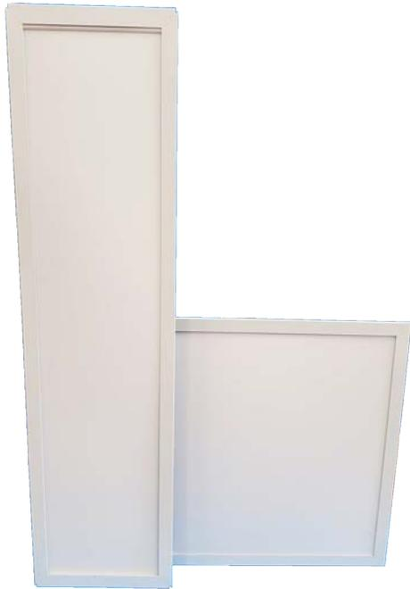
Luminario New Light, serie LED, Tipo Empotrar/Suspender, Cat. NLSPAO- 40WLED-UNIE-AO, / NLSPAO- 40WLED-UNIE-AO / NLSPAO- 75WLED-UNIE-AO. Armadura fabricada de perfiles de aluminio extruido. Equipada con regletas LED de alta intensidad de 4000°K / 5000°K, 1 driver electrónico Philips, remoto 120-277V, 50/60 Hz. Difusor/Refractor de acrílico opalino de alta transmitancia.
