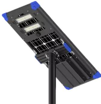
Luminaria fabricada en fundición de aluminio, con pintura en polvo electrostática secada al horno; con panel fotovoltaico monocristalino en lecho superior y lecho inferior; equipada con leds, óptica y driver Philips.
