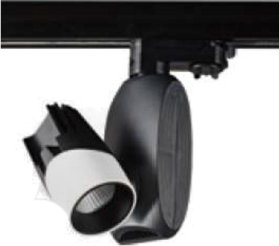
Luminario Track Light led, para colocación en riel, destaca por su diseño y acabado. Cuerpo fabricado en inyección de aluminio con acabado de pintura en polvo electrostática; con reflector de aluminio y rótula que facilita su orientación; ideal para aplicaciones en locales comerciales, museos, restaurantes, etc.
