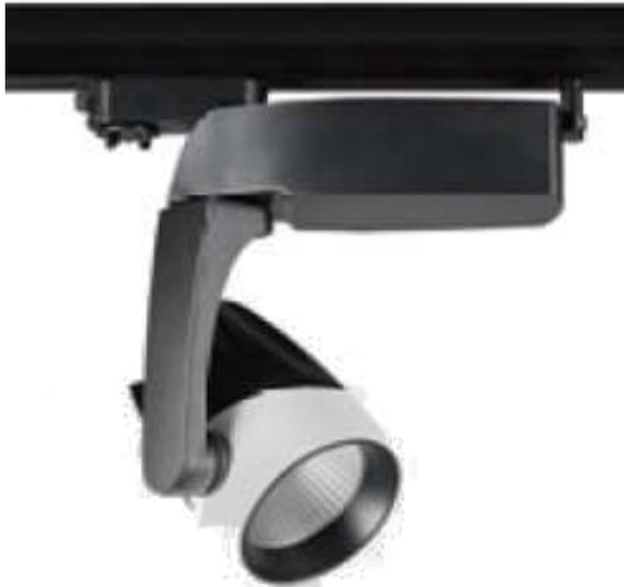
Luminario Track Light led, para colocación en riel, destaca por su diseño y acabado. Cuerpo fabricado en inyección de aluminio con acabado de pintura en polvo electrostática; con reflector de aluminio y rótula que facilita su orientación; ideal para aplicaciones en locales comerciales, museos, restaurantes, etc.
