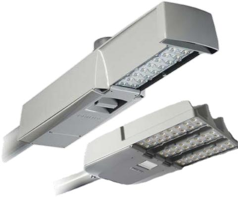
Luminario New Light, serie LED, cat. NLPPSVM-60WLED-UNIE / NLPPMNM-54WLED-UNIE, tipo punta de poste modelo **STREETVIEW / MINI VIEW**. Fabricado en aleación de aluminio fundida en troquel bajo en cobre. Equipada con 1 módulo led de alta intensidad Philips de 60W, 4000°K, con lente para control óptico Curva Tipo LE2, y driver led electrónico Philips Xitanium, 75W, 120-277V, 0.70 Amp, AFP. Con supresor de picos.
