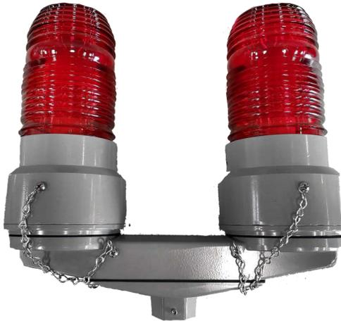
Luminario New Light, serie LED, cat. **NLSLOD-40WLED-127-FR** tipo sobreponer modelo **LUCES DE OBSTRUCCIÓN**. Dimensiones generales: 36.0x34.0x23.0 cms. Fabricado en inyección de aluminio a presión. Equipada con 2 lámparas led A21 Ultraled Sylvania de 20W, c/u, 4000°K, 120V, relevador de transferencia para lámpara doble de obstrucción cuando falla la primera lámpara el relevador transfiere la corriente a la segunda lámpara en espera. Lente Fresnel rojo roscado con visibilidad de 360°.
